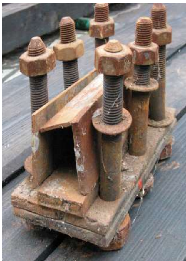
Dispositif pour presser et façonner 5 soules au tour, puis les laisser sécher.
