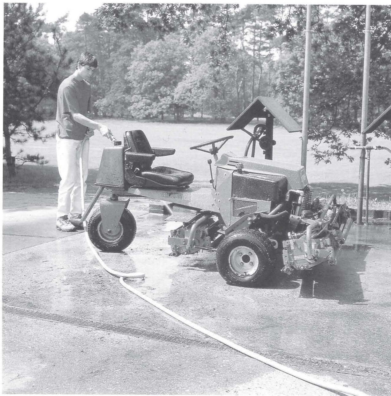
Voor het schoonmaken van de machines dienen voorzieningen te worden getroffen zodat het vuile water niet in de bodem wegloopt
