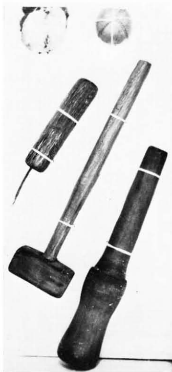
◀ 28 Vitrinekastje met ballenmakersgereedschap De els en de kapotte bal zijn uit vroeger tijd, de rest is recentelijk vervaardigd. Vitrinekastje, hout, 20 x 45 x 10 cm; vorm voor het ronden van de bal, hout, 243 cm; els, hout met metalen priem, 16 cm; hamer, hout, 26 cm; twee ballen, schapenleer gevuld met geloogd koeienhaar; waarvan één opengewerkt, diameter 4 cm De Heemkundige Kring 'De vier Heertganghen', Goirle, Inv.nr. A-173
